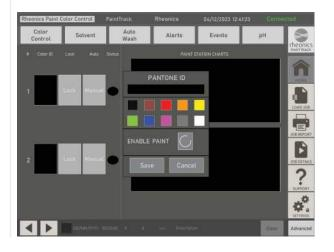
O botão 'Lock' tem duas funções: seleciona o valor de viscosidade medido atual como o setpoint e permite o controle automático durante toda a execução do revestimento.
