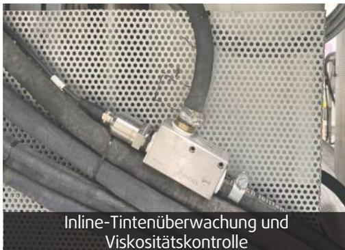
Inline-Tintenüberwachung und Viskositätskontrolle
